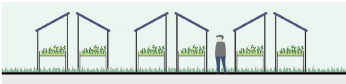
Zonnepanelen in combinatie met teeltondersteunende voorziening
